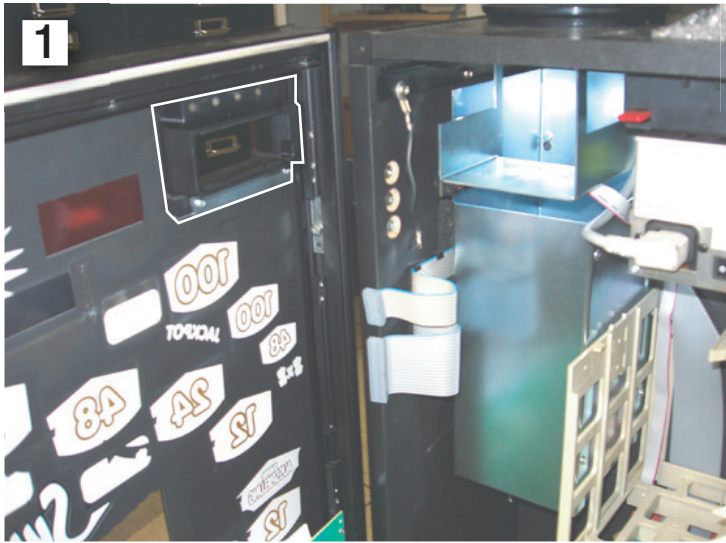
1 Blende wird mit dem Halteblech und den M3 × 6 Schrauben befestigt. Hierzu ist die Scheibe zu entfernen.
